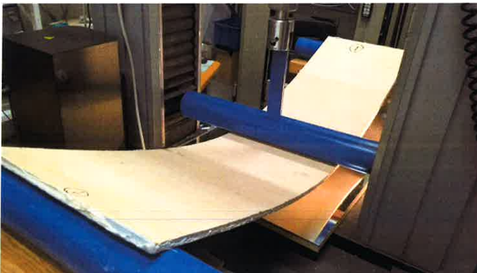
Kuva 6. Pinnoitetun vanerilevyn taivutuskoe.
