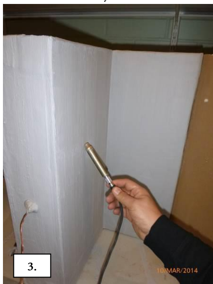
Kuvat 3 ja 4. Materiaali todettiin tiiviiksi ja koejärjestelyn toimivuus varmennettiin tiivistykseen tehdyin testirei'in.
