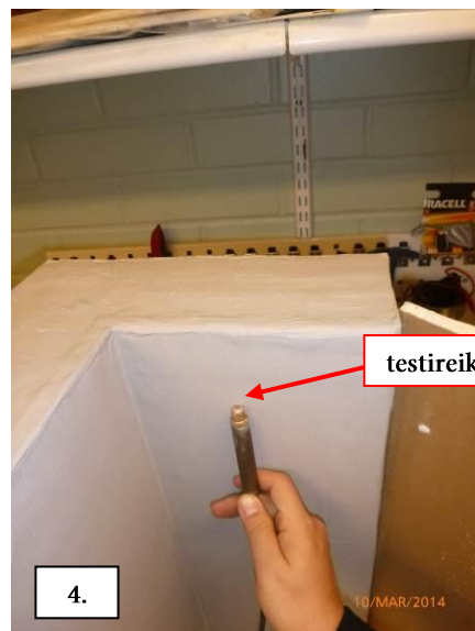
Kuvat 3 ja 4. Materiaali todettiin tiiviiksi ja koejärjestelyn toimivuus varmennettiin tiivistykseen tehdyin testirei'in.
